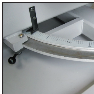
Übersichtliche Gehrungsverstellung (manuell)
