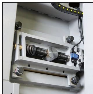
Bandspanneinrichtung durch Endschalter überwacht
